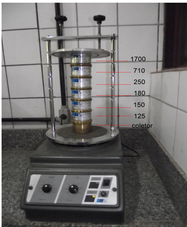
Figura 7 - Tamisador usado para análise granulométrica de *Chrysobalanus icaco* L. com indicação da posição do número de cada tamis em µm (micrômetros).
