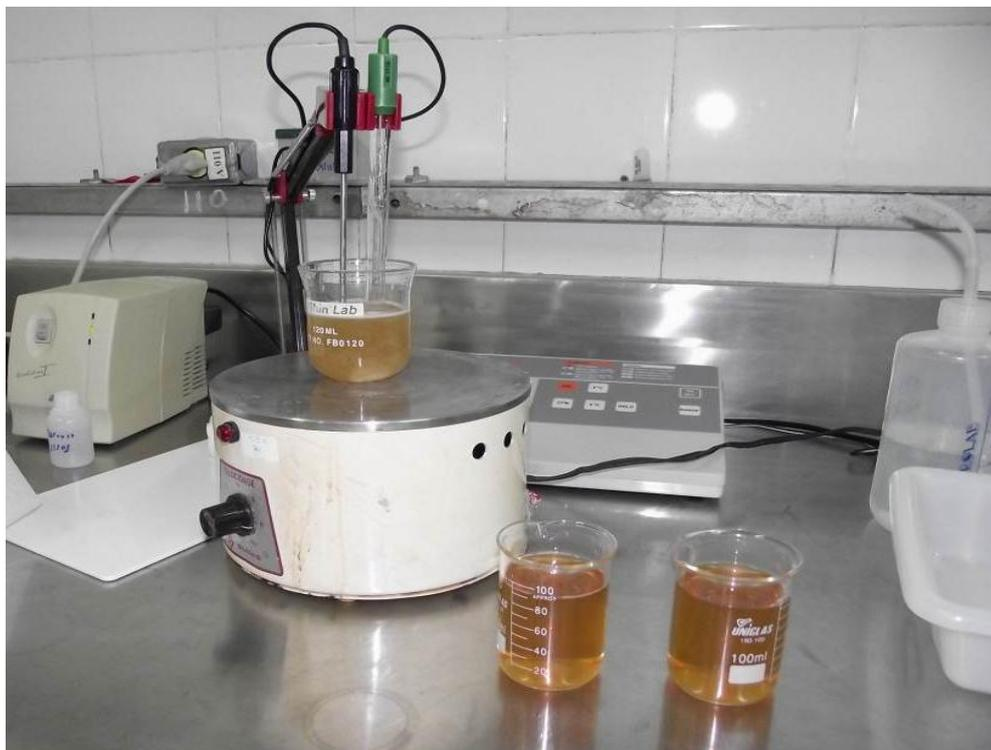
Figura 9 - Medição do pH de *Chrysobalanus icaco* L através de potenciômetro de bancada.
