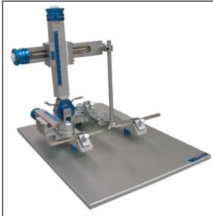
Figura 10: Aparelho estereotáxico. Utilizado para a determinação das coordenadas estereotáxicas e estabelecimento da área para administração de microinjeção de ET-1 ou SSI. Fonte: Insight®.
